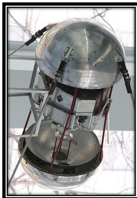
Figura 65: Sputnik 1 com a cúpula aberta, primeiro satélite russo lançado ao espaço em 1957.
